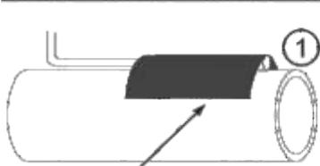
Αυτοκόλλητη μόνωση αισθητήρα
