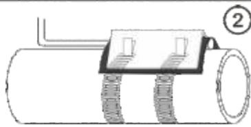
Προστατέψτε τον αισθητήρα με αυτοκόλλητη μόνωση (1) και έπειτα προσαρμόστε το στήριγμα (2), σύμφωνα με το σχήμα.
